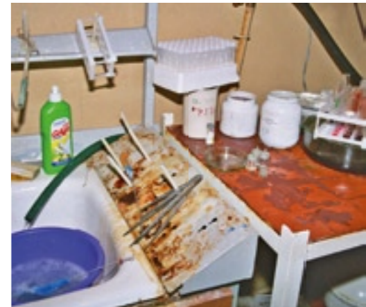
Laborwaschbecken: das ist kein Schmutz, sondern Rost
